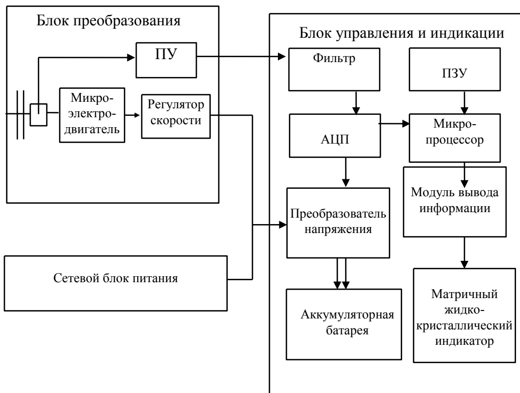
Рисунок 2. Функциональная схема измерителя.
